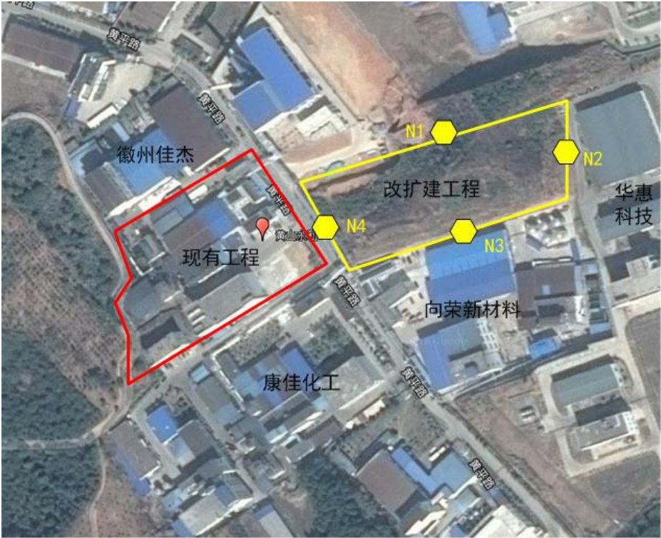
图4.3-1 技改工程噪声现状监测点
